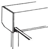
Standardausführung Linksroller mit Gurtbedienung Gurtaustritt unten (Wahlweise mit Schnur) Außenkante Kasten bis Mitte Gurt 16 mm
